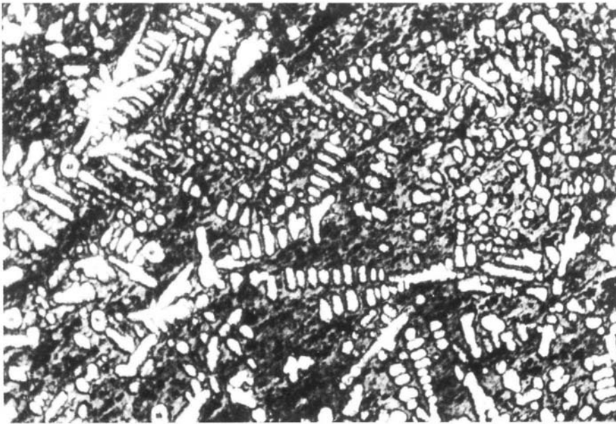
Fig. 3 – Lingote de cobre de Leceia: Vista da secção A (x100), observando-se dendrites (de cobre?) na parte rica em escória. (Fotos de M. Carriço).
