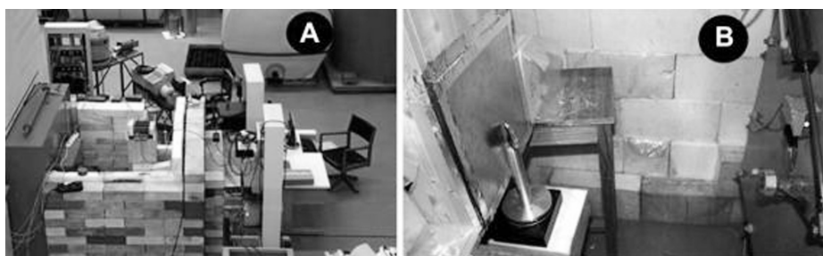
Fig. 3 – Imagens do equipamento de tomografia de neutrões (TN) do Reactor Português de Investigação (RPI): (A) visão externa da blindagem e mesa de controlo; (B) detalhe interno do equipamento com a saída do feixe de neutrões e a mesa rotatória com a amostra do azulejo MNA.
