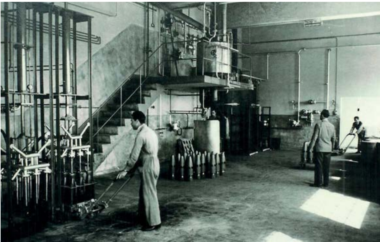
Fig. 70 – Enchimento de obuses de artilharia. Arquivo CMO. Reprodução fotográfica de J. L. Cardoso.
