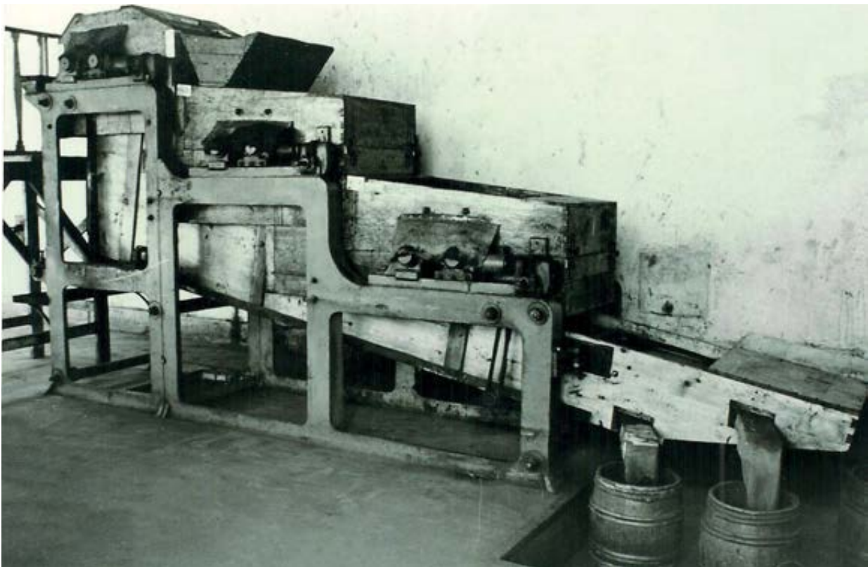
Fig. 34 – Aparelho de granização instalado na margem direita da ribeira de Barcarena, em pleno funcionamento, com a saída da pólvora para o enchimento de barricas. Arquivo CMO. Reprodução fotográfica de J. L. Cardoso.
