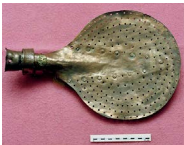
Fig. 31 – Escumadeira para a recolha do líquido salitroso em processo de cristalização por aquecimento. Museu da Pólvora Negra. Foto de J. L. Cardoso.
