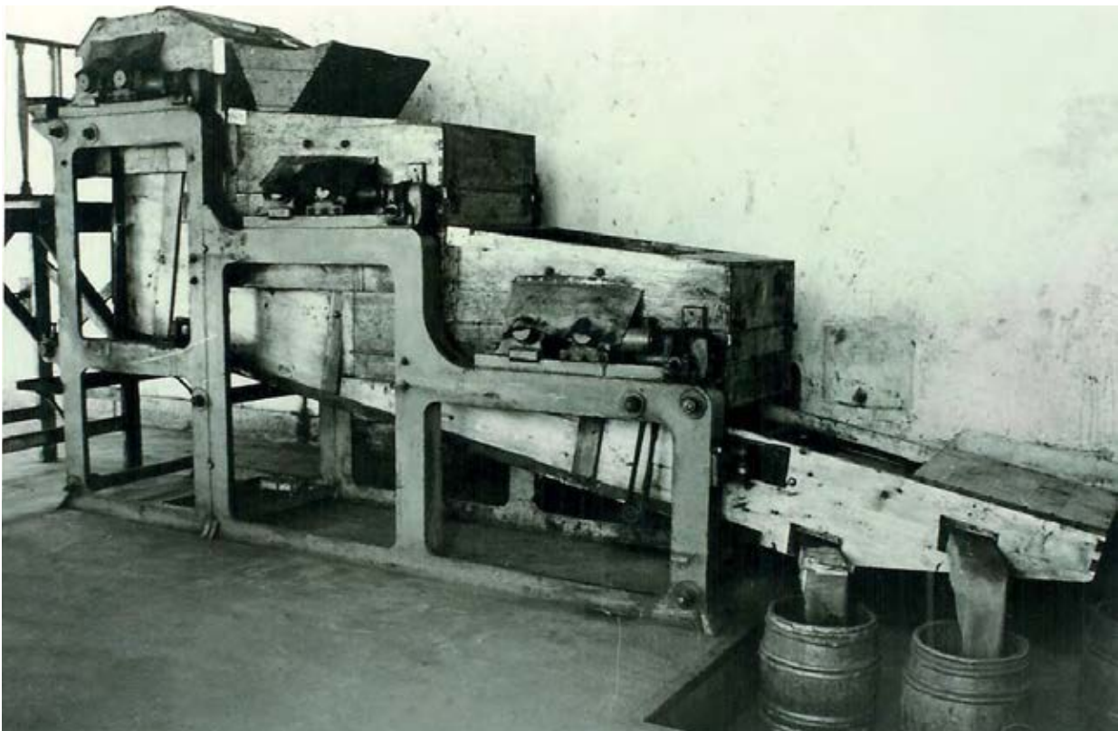
Fig. 34 – Aparelho de granização instalado na margem direita da ribeira de Barcarena, em pleno funcionamento, com a saída da pólvora para o enchimento de barricas. Foto antiga, arquivo CMO. Reprodução fotográfica de J. L. Cardoso.
