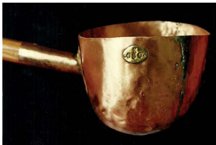
Fig. 32 – Casso para o caldeamento do líquido salitroso em processo de cristalização por aquecimento. Museu da Pólvora Negra. Foto de J. L. Cardoso.
