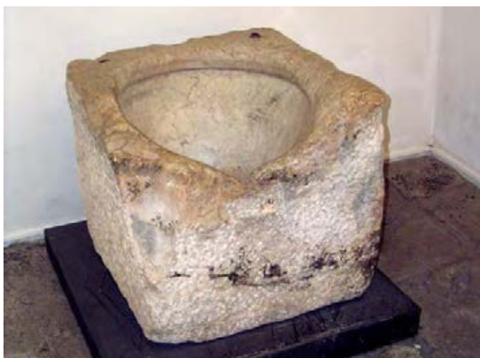
Fig. 13 – Almofariz da antiga Fábrica da Pólvora de pilões, exposto no Museu da Pólvora negra. Foto de J. L. Cardoso.
