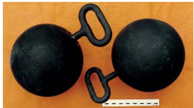
Fig. 57 – Dois globos dos morteiros-provete de ferro fundido, oriundos da Fábrica de Beirolas, oferecidos à Câmara Municipal de Oeiras pelo INDEP. Museu da Pólvora Negra. Foto de J. L. Cardoso.
