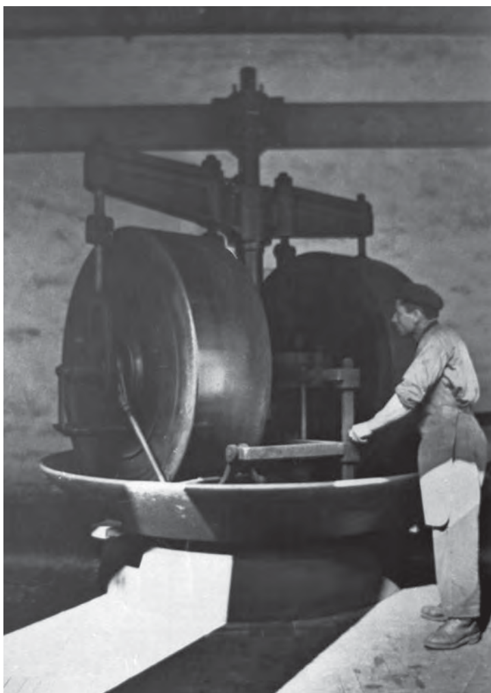
Fig. 51 – Galgas eléctricas de ferro fundido da fabrico alemão da década de 1920, podendo ler-se no pé dos pratos, de ferro fundido, a seguinte inscrição: FRIED. KRUPP AKT.GES. GRUSONWERK MAGDEBURG. Foto antiga, arquivo CMO. Reprodução fotográfica de J. L. Cardoso.
