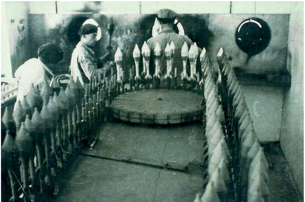
Fig. 71 – Enchimento de morteiros-foguete (“panzerfaust”). Foto antiga, arquivo CMO. Reprodução fotográfica de J. L. Cardoso.
