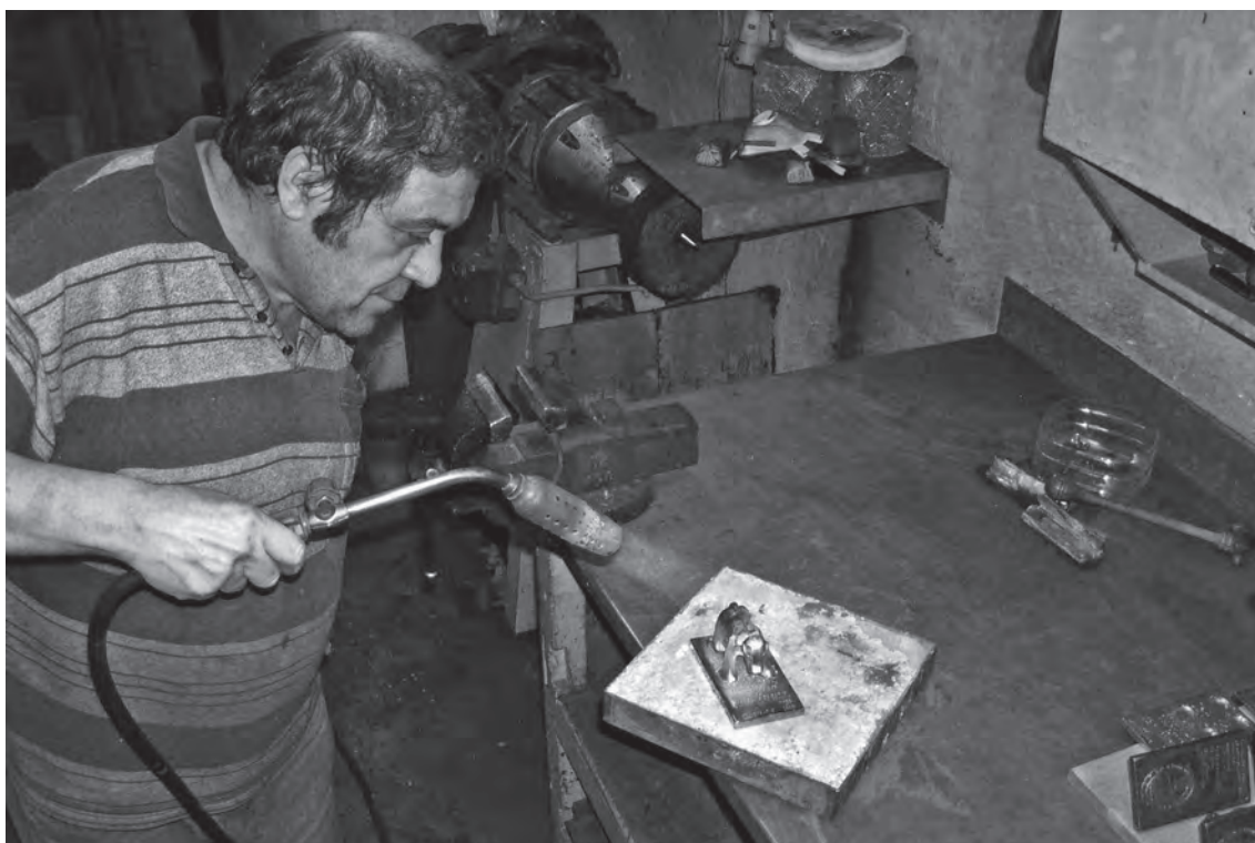
Fig. 392 – 2008 – Execução artesanal da escultura fundida de cobre da Fig. 391 pela firma Salvador Nunes Cid Herdeiros, Fundições de Metais (Lisboa).
